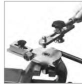
7. Zum Herausnehmen des Rohrbogens Gegenhalter lösen. Rohrbogen herausnehmen, bei komplizierten Biegeformen eventuell Hebelvorrichtung und Biegerolle entfernen.
