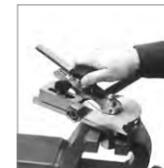
5. Einstellbare Hebelvorrichtung aufstecken und entsprechend dem Rohr-AD arretieren.
