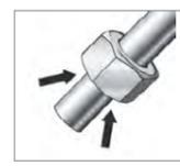
**3. Systemmutter auf Rohr schieben**
