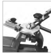
6. Hebelverlängerung aufstecken. Zügiges Biegen bis kurz vor die gewünschte Endform. Während des Biegevorganges Rohr von Hand leicht mitziehen. Durch langsames Nachziehen wird gewünschter Biegewinkel erreicht.
